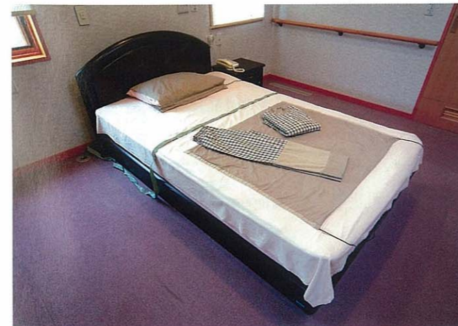
寝ている間に心電図を測定できるベッド。パジャマに電極が入っている。天井にはマイクと呼吸センサーを内蔵している
